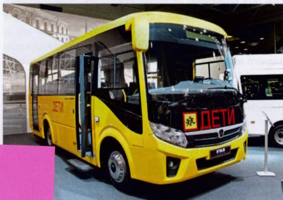
← У школьной версии Vector NEXT – две автоматические двери поворотного типа и дополнительные выдвигаемые подножки под порогами
