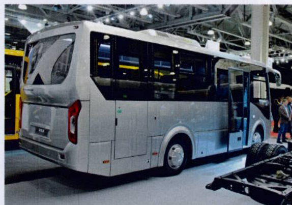
→ У междугородного Vector NEXT автоматическая дверь всего одна – передняя, причем она здесь уже прислонно-сдвижного типа. А задняя распашная дверь используется лишь в качестве запасной
